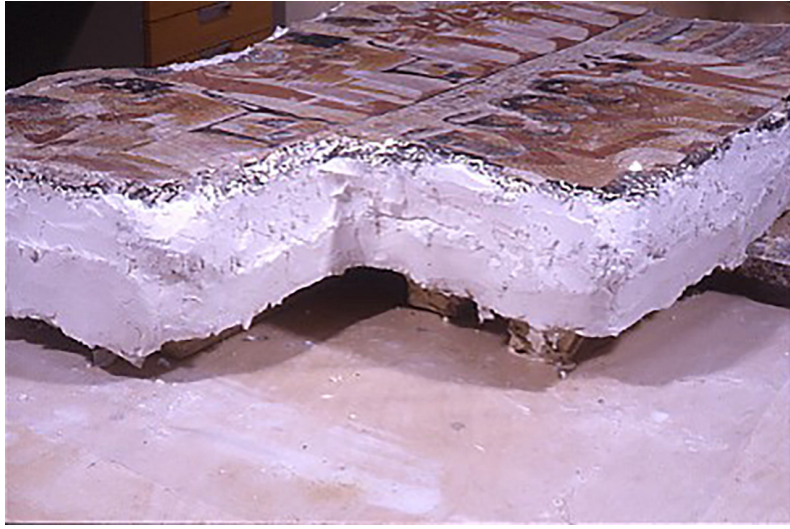
الصورة ١١: رسومات 'نب آمون': الطبقة الفاصلة من عجينة بارالويد BV2 وبالونات زجاجية دقيقة المستخدمة بين طبقة 'أريتشو' وراتنج الإيبوكسي الرغوي (الصورة بتصريح من أمناء المتحف البريطاني)
